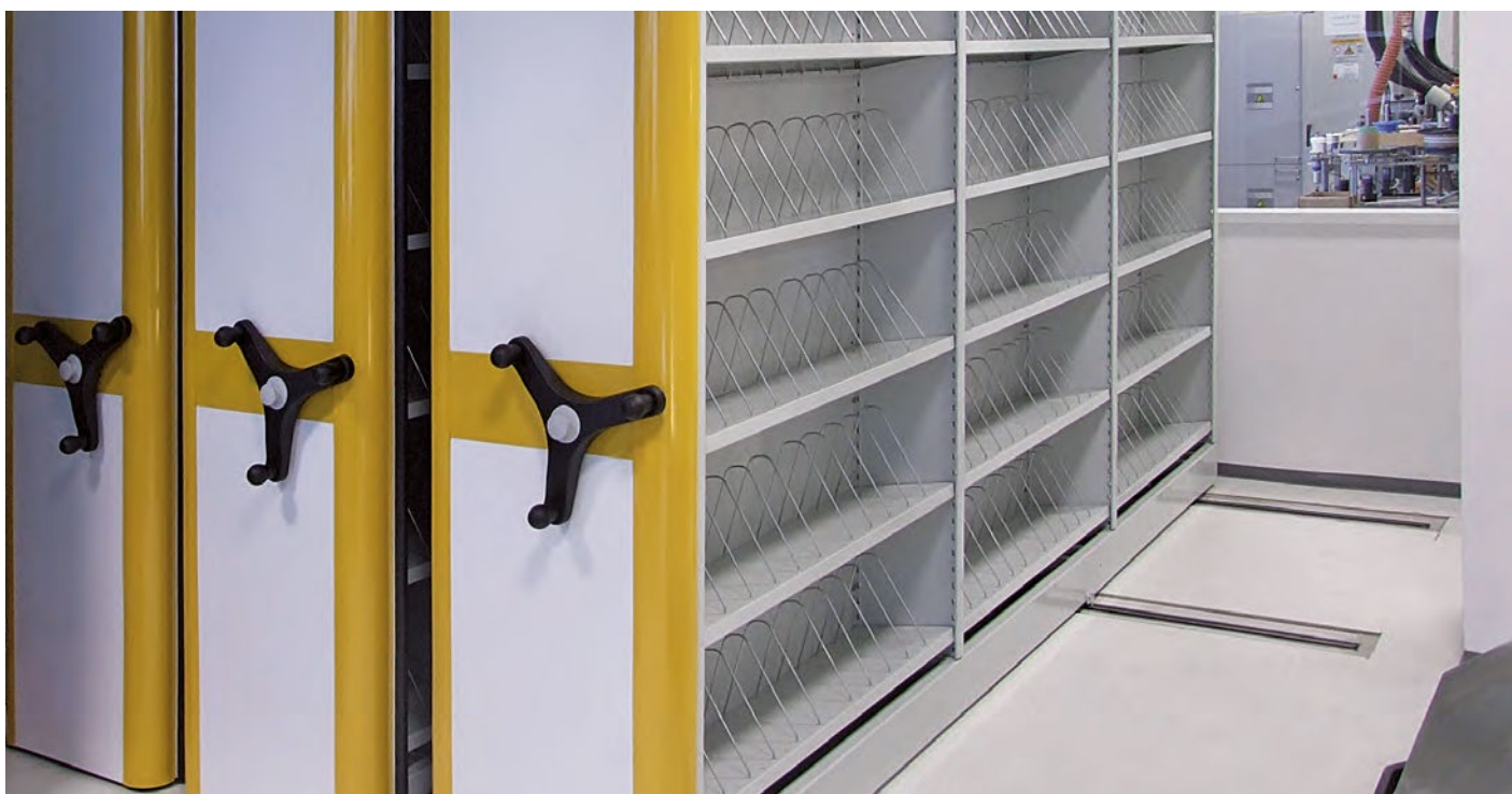
Rayonnage mobile ACTI-LONE, sur rails directement encastrés dans le sol en béton. Les chariots sont personnalisés avec des coloris de la gamme RAL et les tablettes sont équipées de séparateurs
